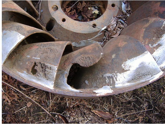
Figure 8: Imagem de uma turbina danificada pelo efeito de cavitação
