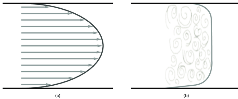
Figure 23: Perfil de velocidades de um escoamento laminar versus um turbulento
