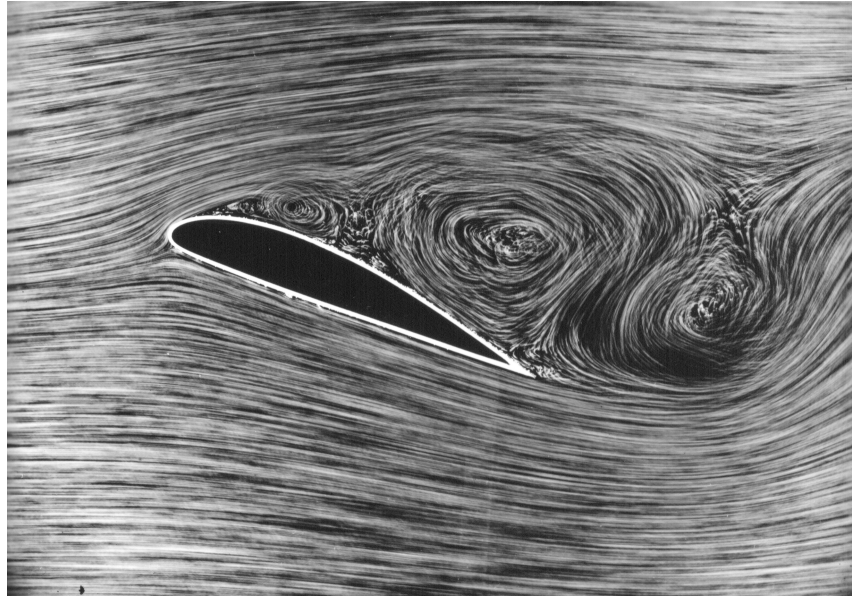
Figure 55: Formação de vórtices atrás de um aerofólio
